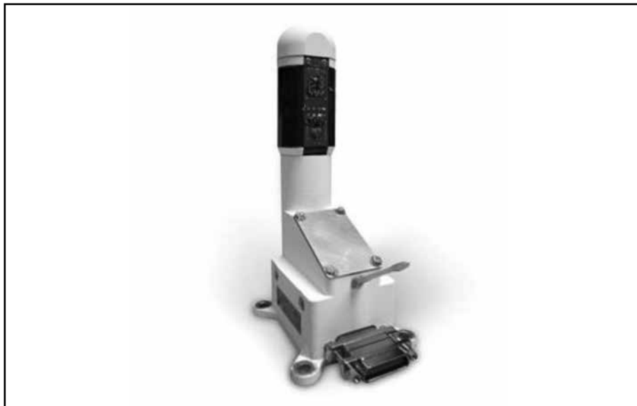
Fig. 2. Botavara de TWINS , formado por dos dispositivos idénticos que alojan los sensores de viento y temperatura del aire. Estos fueron originalmente los modelos de repuesto ( spare s) del instrumento de vuelo REMS , desarrollado por Airbus (Tres Cantos) y que está instalado a bordo el rover Curiosity . Una vez que fue lanzado el Curiosity , los de repuesto fueron rediseñados y calibrados exhaustivamente, optimizando así las prestaciones científicas de sus medidas para la misión InSight ( https://bit.ly/3NZZNcG ).
